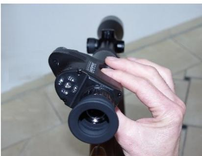
**Die Scharfsteller-Walze sollte grundsätzlich mit 2 Fingern bedient werden, um Schäden im Gerät vorzubeugen!**
